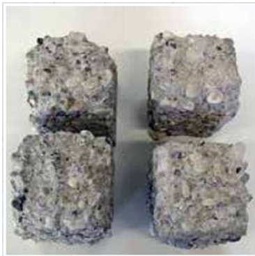
Pav. 5 Betoniniai pavyzdžiai po šildymo-šaldymo ciklų neapdorojus apsauginiu impregnantu. Akivaizdus pavyzdžio masės praradimas
