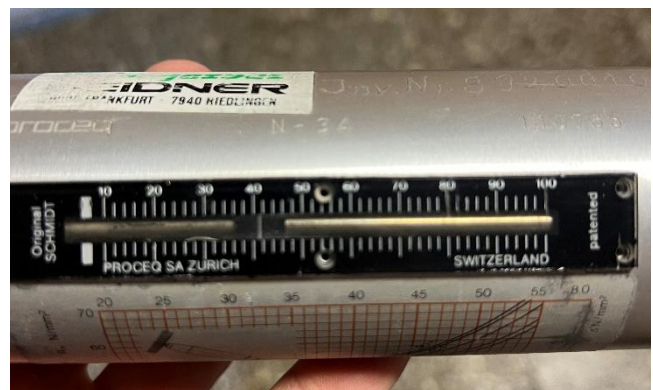
6 pav. Nustatytas perdangos plokščių betono stipris
